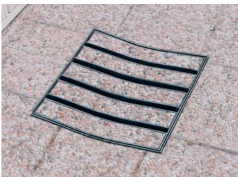
Griglia quadrata in ghisa sferoidale EN-GJS-500-7 conforme alla norma EN 1563:2018 con resistenza a rottura superiore 250KN (25 t) conforme alle classi di carico C250 prevista dalla norma EN 124:2015
